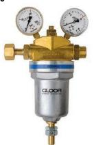
С манометрами для контроля входного и рабочего давлением и встроенным предохранительным клапаном. С присоединением для трубопроводов и предохранительным клапаном для стравливания газа в атмосферу. Стандартная версия с рабочим давлением до 10 бар. Также доступен с рабочими давлениями до 20 или 30 бар (см. ниже).
