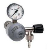
Регулятор давления с манометром входного давления, но без манометра рабочего давления; с заданным рабочим давлением и встроенным предохранительным клапаном. Шпиндель позволяет точное регулирование маленьких количеств газа (также для проветривания аквариумов).
