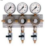
Регуляторы низкого давления из латуни с никелевым покрытием. Закрытое размещение винта регулировки давления. Фильтр из спечённой бронзы; диафрагма из неопрена EFFBE. Манометр низкого давления со шкалой масштаба 1/10 бар, как опции 0 - 4 бар, 0 - 6 бар или 0 - 10 бар и с соответствующими маркировками в 3, 4 или 7 бар.
