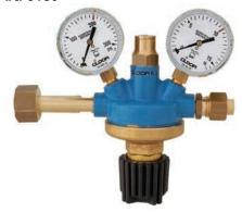
Этот регулятор давления имеет ту же самую конструкцию, что и Art.-№ 5100 и подходит как центральный регулятор давления для небольших систем газоснабжения. Также доступен с рабочим давлением до 60 бар. С длинной трубкой, предохранительным клапаном для стравливания газа в атмосферу.
