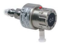
Расходомер для медицинских газов. Для точного распределения медицинских газов от центральной подачи системы газов. С газовым штуцером для каждого национального стандарта (или штуцер NIST) для прямого соединения с медицинским оборудованием (настенный газораздаточный пост). Задан на давление 4,5 бар. Доступен в двух версиях расхода: 0 - 5 л/мин или 0 - 15 л/мин.
