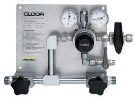
Ручная станция переключения для газов высокой чистоты (до 6.0); состоит из двух отсечных клапанов высокого давления для попеременного подключения газовых баллонов, главный регулятор давления с предохранительным клапаном, включая клапан продувки с угловой частью. Все детали закреплены на алюминиевой опорной пластине с идентификацией газов и табличкой с примечаниями относительно переключения. Опции:
