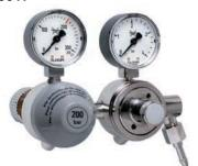
Двухступенчатый регулятор давления с индикаторами входного и рабочего давления. Особенно подходит для применений, требующих очень постоянного вторичного давления. Рабочее давление, заданное от 0,5 до 3 бар (как требуется). Также доступен с диафрагмой с тефлоновым покрытием для аналитического оборудования.
