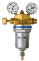
Регулятор давления для большого давления и большого расхода (конструкция такая же, как Art. 7900, но для входного давления до 300 бар). С манометрами для входного и рабочего давления и встроенным предохранительным клапаном. Стандартная версия с рабочим давлением до 10 бар. Также доступен с рабочими давлениями до 20 или 30 бар (см. ниже). Присоединение: накидная гайка для баллонного вентиля (по ISO 5145)
