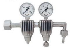
Двухступенчатый регулятор давления с индикатором для регулирования расхода. Из-за увеличенной поверхности корпуса (большая поверхность предотвращает формирование льда) этот регулятор давления особенно подходит для применения для газовой защиты без предварительного подогрева газа.
