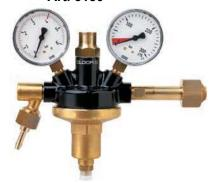
Регулятор высокого давления с цилиндрическим штуцером и/или с настенной скобой для присоединения шланга высокого давления. Альтернативно для углекислого газа, азота или газовых смесей. Входное давление показывается манометром с красной маркировкой, манометр рабочего давления со шкалой масштаба 1/10 и с маркировкой максимального давления в 3, 4 или 7 бар.
