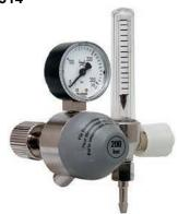
Регулятор давления с индикаторами (манометрами) для входного и рабочего давления, встроенным предохранительным клапаном и клапаном отключения на выходном отверстии. Входное отверстие в задней части, регулировочный винт давления во фронтальной части. Материал: латунь с никелевым покрытием. Фильтр из спечённой бронзы, диафрагма из неопренового EFFBE.
