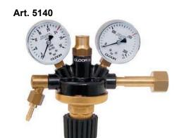
Регулятор давления с индикатором расхода, то есть с градуировкой "л/мин" на вторичном манометре. Встроенный предохранительный клапан. Этот регулятор давления - эффективная по затратам альтернатива Art.-№ 5150. С этой системой расход регулируется изменением вторичного давления (также через дросселирующий клапан на выходном отверстии).
