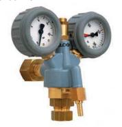
Регулятор высокого давления с цилиндрическим штуцером. Альтернативно для углекислого газа, азота или газовых смесей. Входное давление показывается манометром с красной маркировкой, индикатор рабочего давления для максимального давления 7 бар.
