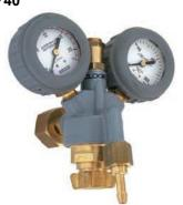
Мини-регулятор давления с индикатором расхода, то есть с градуировкой "л/мин" на вторичном манометре. Встроенный предохранительный клапан. Расход меняется регулировочным винтом изменением вторичного давления и через дросселирующий клапан на выходном отверстии.
