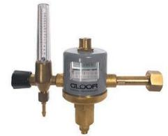
С установленным ротаметром и манометром в цилиндрическом корпусе. Встроенный предохранительный клапан и отсечной клапан на ротаметре. Точность измерения расхода ±10%. Доступен с тремя значениями расхода (см. ниже).
