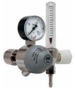
Регулятор давления с индикатором входного давления (манометром) и ротаметром; встроенный предохранительный клапан. Ротаметр гарантирует удобное считывание установленного расхода. Диафрагма из неопрена EFFBE; по запросу также доступен с диафрагмой с тефлоновым покрытием.
