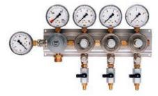
Комбинированная станция понижения давления с высоким / низким давлением моноблочной конструкции. Регулятор давления из латуни с никелевым покрытием. Закрытое размещение винта регулировки давления. Фильтр из спечённой бронзы; диафрагма из неопрена EFFBE. Манометр низкого давления со шкалой масштаба 1/10 бар, как опции 0 - 4 бар, 0 - 6 бар или 0 - 10 бар и с соответствующими маркировками в 3, 4 или 7 бар.
