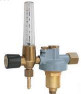
Регулятор низкого давления с встроенным ротаметром и отсечным клапаном. Ротаметр гарантирует удобное считывание установленного расхода. Точность измерения расхода измеряет ±10%. Доступен для трёх диапазонов расхода (см. ниже). Также доступен с клапаном вентиляции на выходном отверстии.
